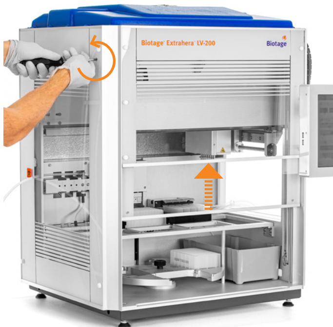
Figura 14. Aprire lo sportello manualmente ruotando la vite in senso antiorario.
