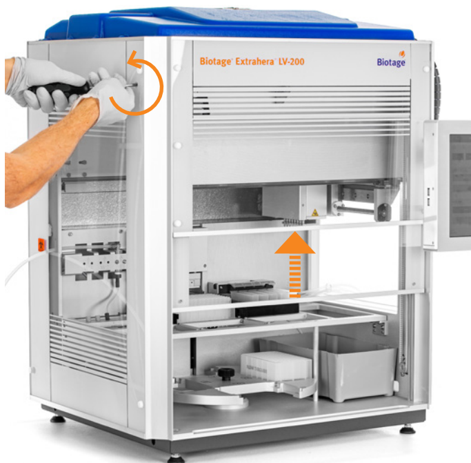
Figur 14. Åbn døren manuelt ved at dreje skruen imod urets retning.
