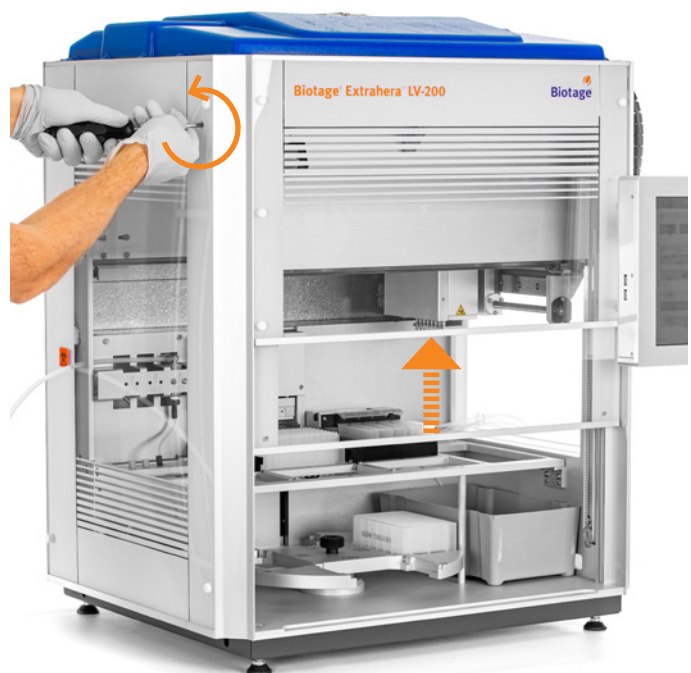
Figura 14. Abra a porta manualmente, rodando o parafuso para a esquerda.
