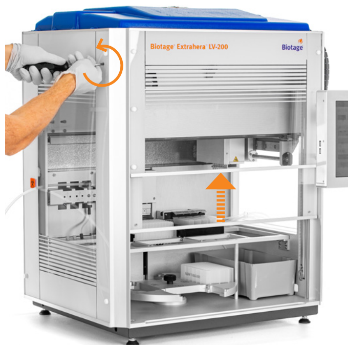
Afbeelding 14. Open de deur handmatig door de schroef linksom te draaien.
