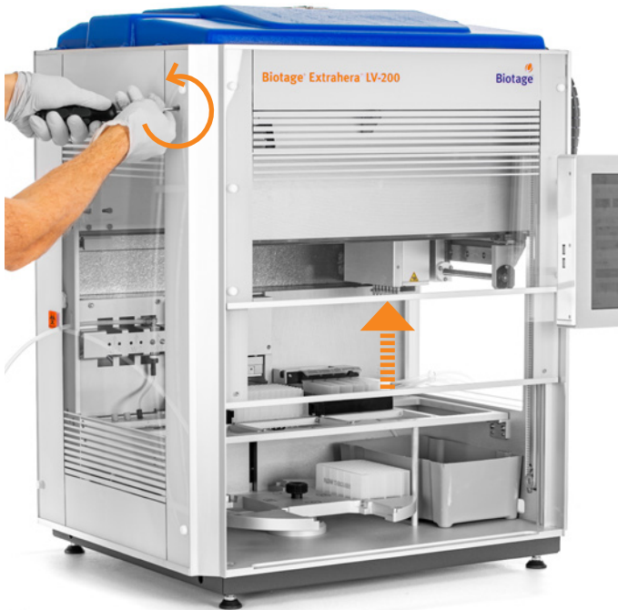
Kuva 14. Avaa ovi manuaalisesti kääntämällä ruuvia vastapäivään.
