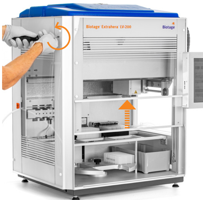
图14. 逆时针拧动螺钉，将舱门手动打开。
