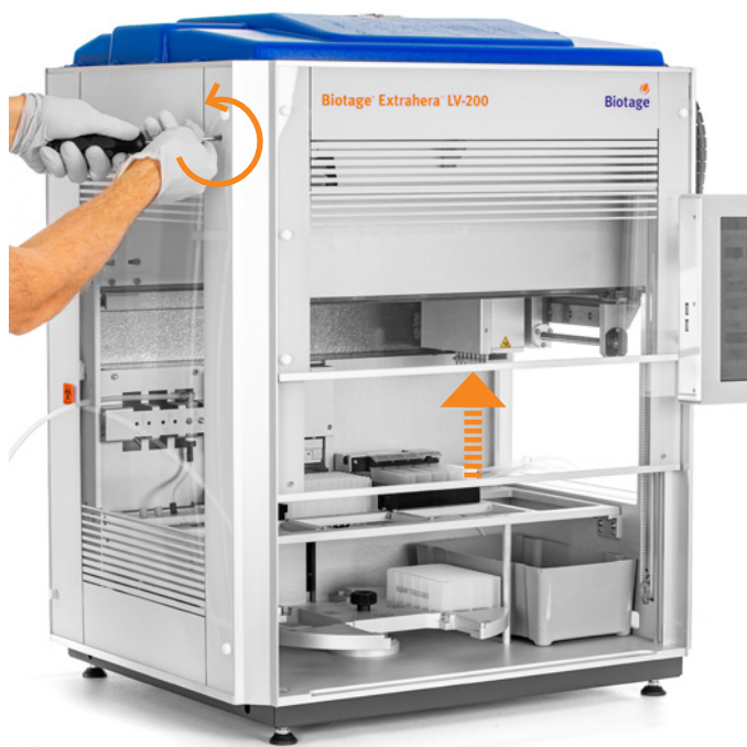
Abbildung 14. Öffnen Sie die Tür manuell, indem Sie die Schraube gegen den Uhrzeigersinn drehen.
