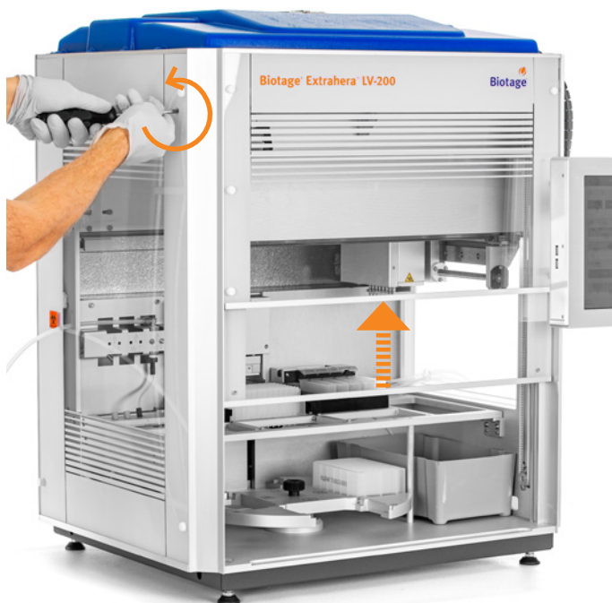
図 14. ネジを反時計方向に回して、ドアを手で開けてください。
