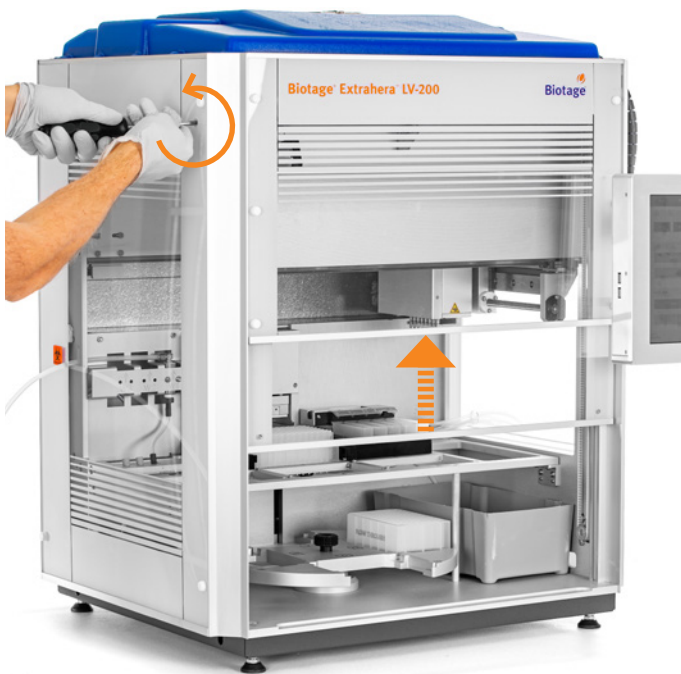
Bild 14. Öppna dörren manuellt genom att vrida skruven moturs.
