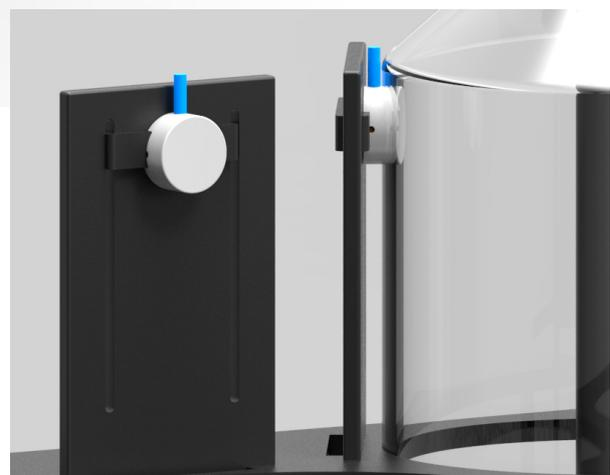
Halterung für Scheibenfüllstandssensor.
