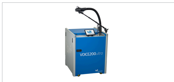
Figure 2: Syft Technologies Voice 200ultra SIFT-MS.
