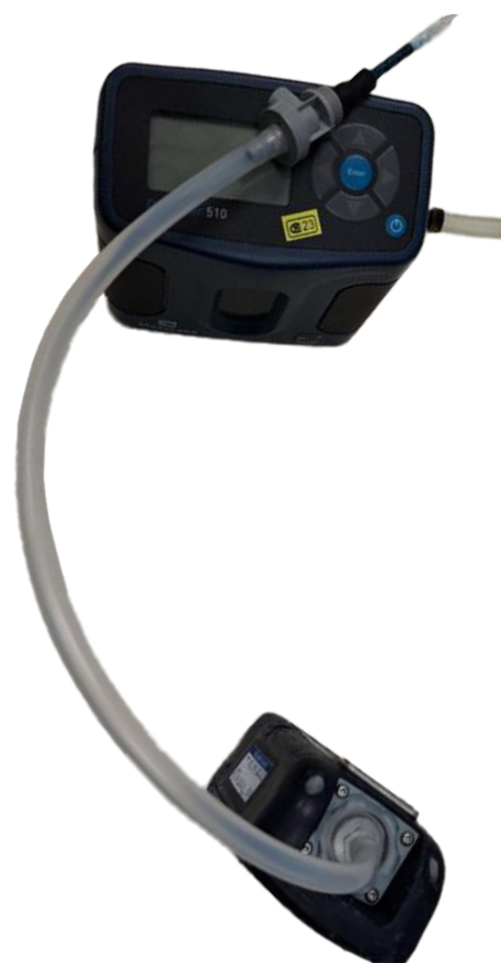
Obrázok 3. Odberové čerpadlo vzorkovacou trubičkou
