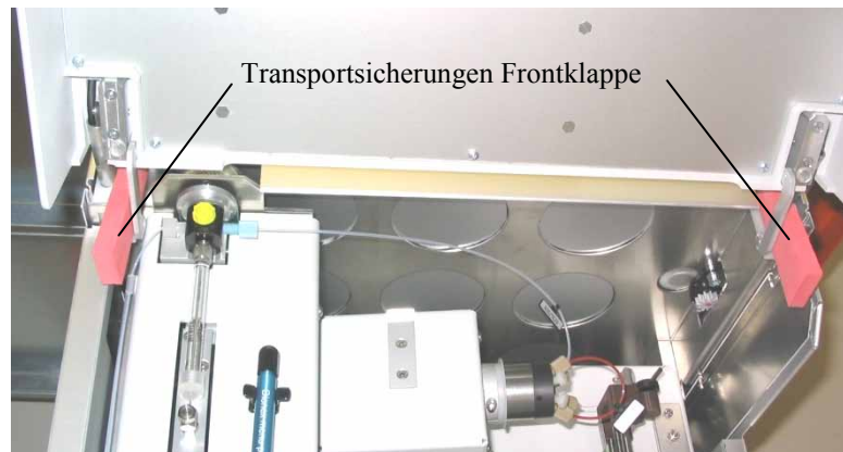
Abb. 2: Transportsicherung Frontklappe (hier WPS-3000PL)
